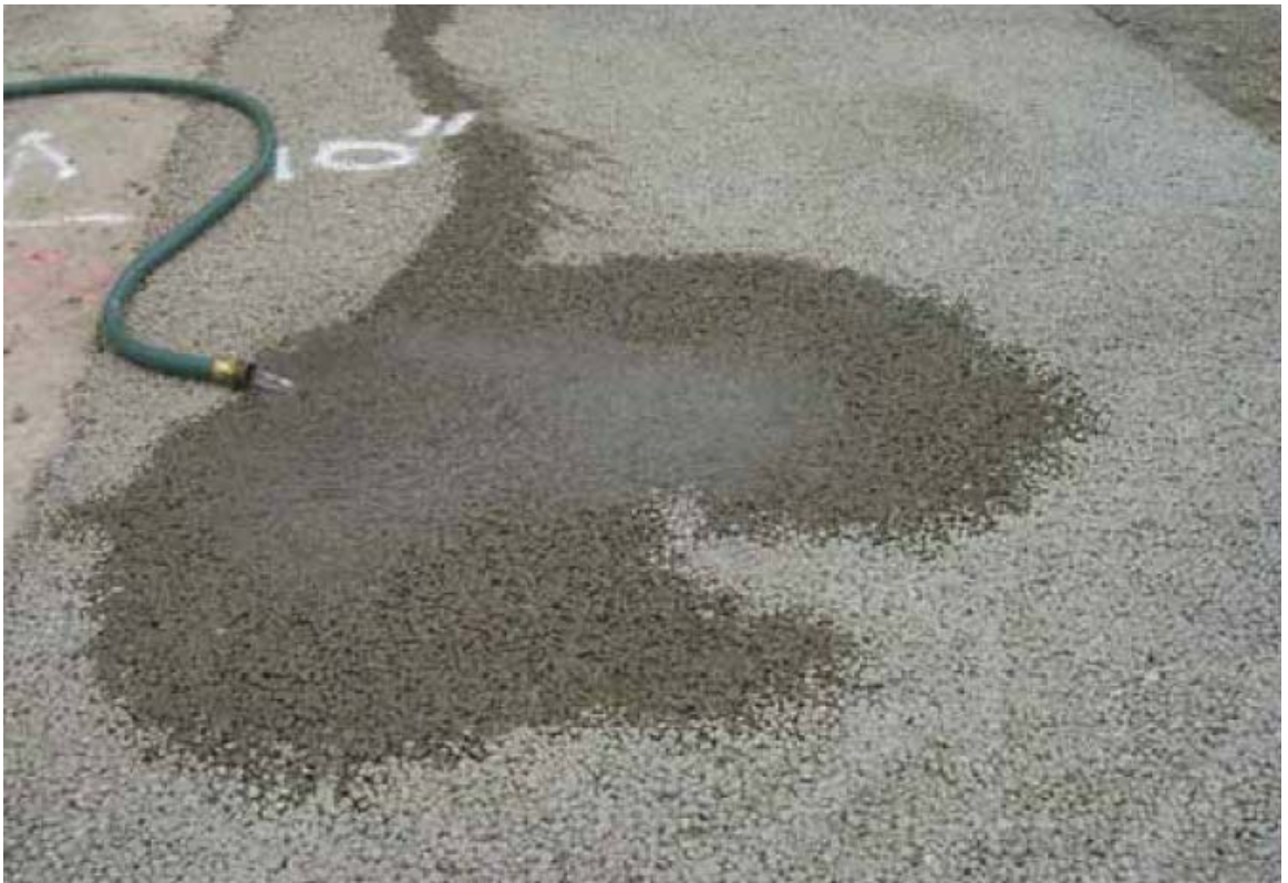
圖 6.5.8 道路透水性鋪面
